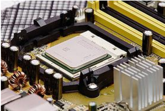
- Microprocesador de 64 bits doble núcleo, el AMD Athlon 64 X2 3600.
