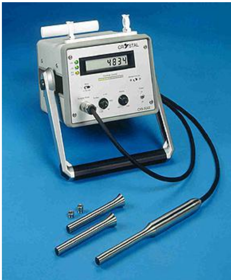
-Figura 10. Cámara-gamma con sonda manual para uso intraoperatorio que sirve para detectar el ganglio centinela después de una inyección de sustancia coloide radiactiva alrededor del tumor primario.
