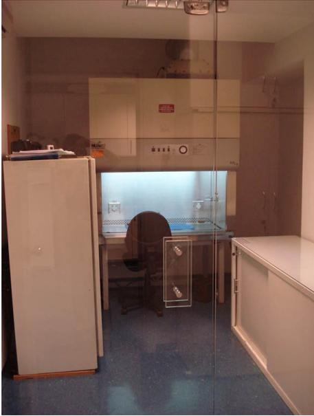
Imagen N°21 Cámara de flujo laminar
