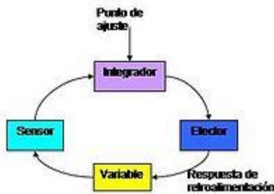
Figura 1. Componentes de un sistema de retroalimentación.
