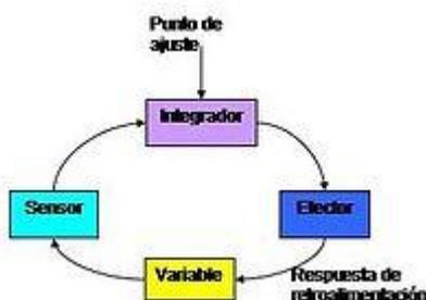
Figura 1. Componentes de un sistema de retroalimentación.
