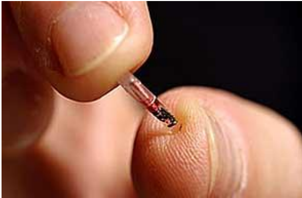
- Sensor implantable para medir glucemia
